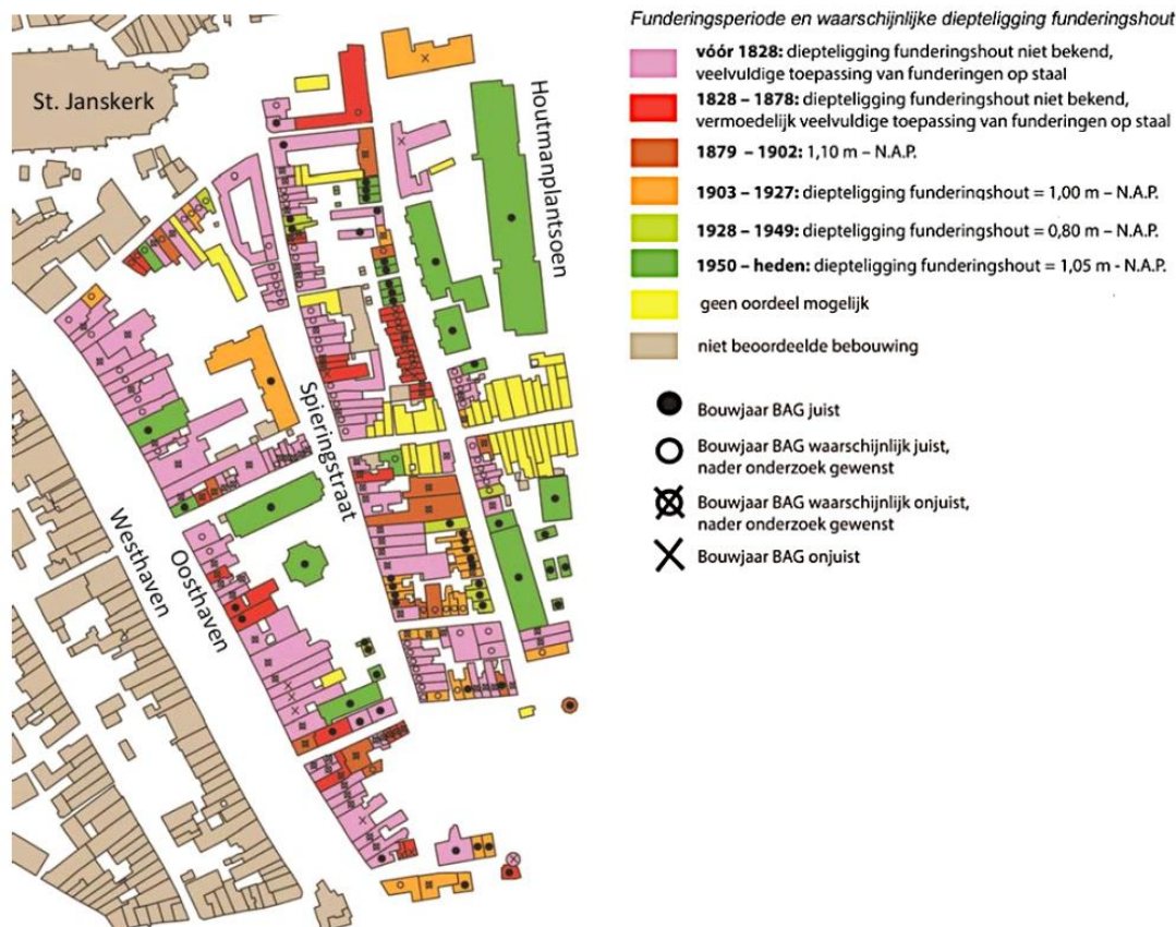
Figuur 4.6 Funderingsperiode en mogelijke diepteligging funderingshout in Gouda [Winsen et al 2015].
