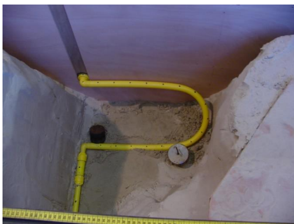
Figuur 10.2: Proef met horizontaal flexibel element.
